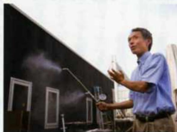
従来は圧縮した空気でもスト状にしていたが、直接、水を圧縮する技術を新開発。ノズル2個分で70Wとエアコンの10分の1の消費電力だ。
